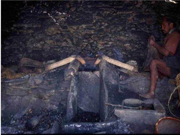
*Figur 1: Koppersmelting fra Nepal med ovnen som ble benyttet.*
